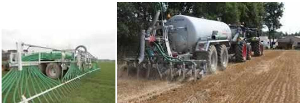
Figure 6 : Exemple de pendillard et d'enfouisseur.
